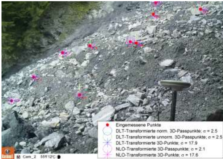
Abbildung 26. Eingemessene Punkte, Rückprojektionen der Passpunkte sowie aller Punkte mit DLT (zum Vergleich auch unnormiert) und mit Nicht-Linearer-Optimierung (NLO), am Beispiel der Flowcam 2. Jeweils angegeben ist der mittlere Fehler in Pixel (Gesamtauflösung 3264 x 2448).
