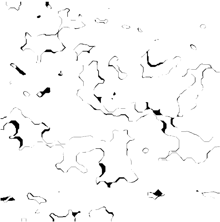
Abbildung 97. Resultat der kontravalenten Verknüpfung zweier Zeitschritte (XOR).
