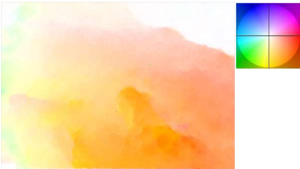
Abbildung 32. Beispiel des Optical Flow für Flowcam 3, mit Farbkodierung Middlebury dargestellt (rechts). Die Farbkodierung Middlebury beinhaltet die Richtung (z.B. nach unten links = grün) sowie die Intensität.
