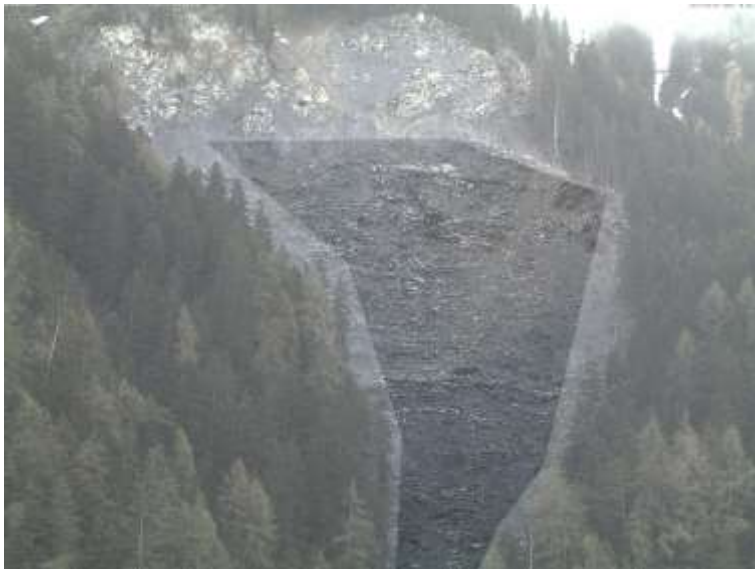
Abbildung 63. Beispielbild der Webcam Schöneegg. Der aufgehellte Bereich aussen wird für die Berechnung der fractional snow-covered area nicht berücksichtigt. Von den Flowcams wurde ebenfalls nur der zentrale Ausschnitt (ohne Vegetation am Gerinnerand) herangezogen.
