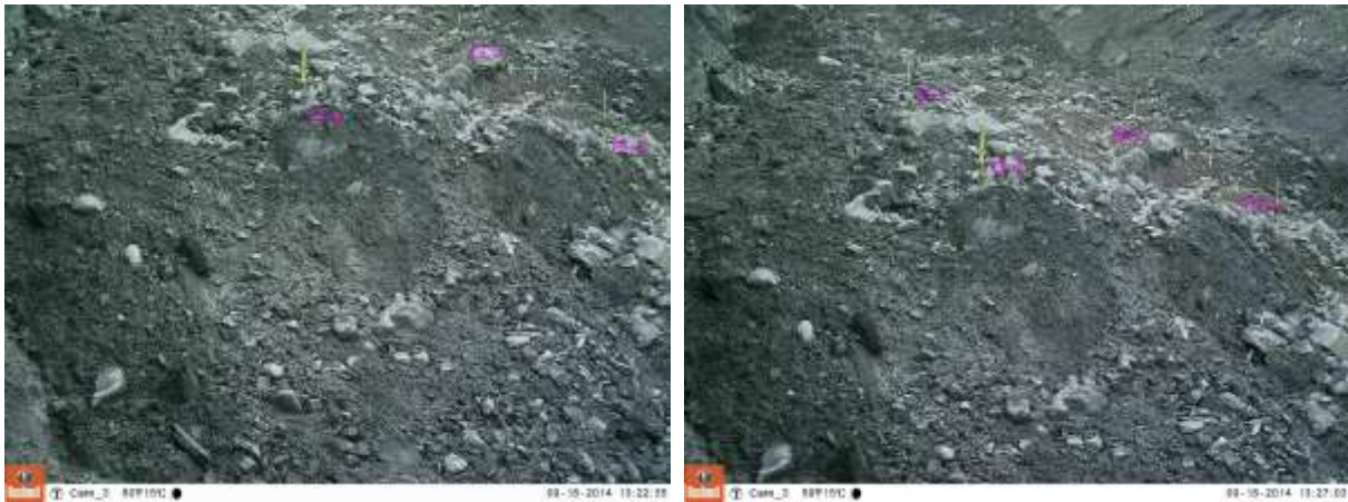
Abbildung 24. Messpunkte für Flowcam 3. Da erst nach dem Einmessen mit GPS bemerkt wurde, dass nicht alle Messpunkte innerhalb des Bildfeldes liegen (links), wurde die Ausrichtung der Flowcam angepasst (rechts). Für Berechnungen wurde die Einstellung links (Flowcam 3 bis 18. September 13:25 Uhr MEZ) als Flowcam 5 bezeichnet.
